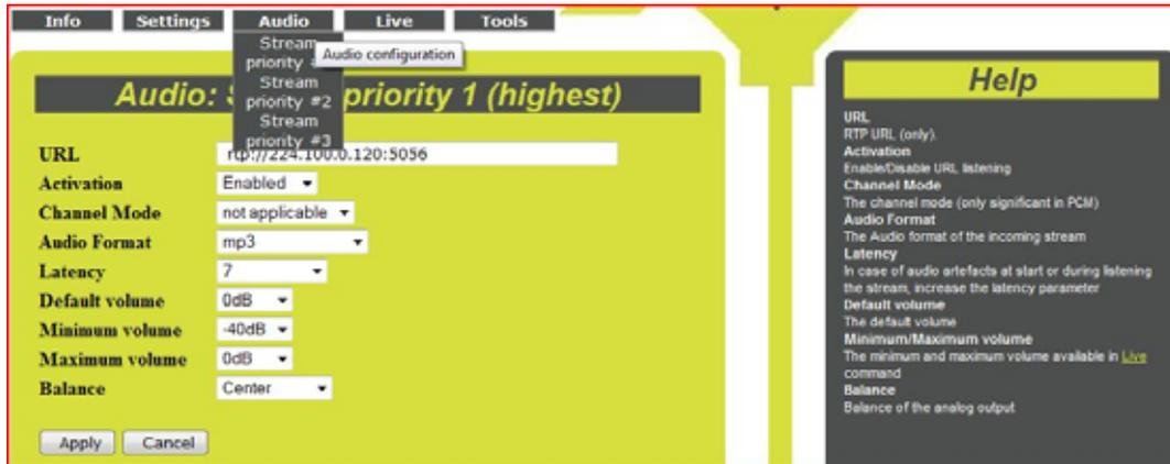
C'est le niveau de priorité le plus élevé (typiquement le flux principal à décoder pour une application broadcast). Seul un flux RTP peut être déclaré. Les paramètres du flux sont les suivants :
