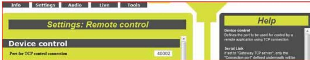
PYKO peut être piloté via des commandes TCP ASCII. Le port TCP utilisé par le PYKO pour recevoir les commandes TCP doit être paramétré dans la section « **Device Control** », paramètre « **Port for TCP control connection** ». Ce port est le port de destination utilisé par une application de contrôle distant à travers le réseau pour envoyer les commandes TCP au PYKO.
