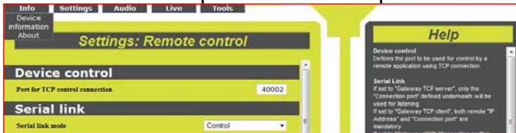
PYKO peut être piloté localement via des commandes ASCII envoyée sur son port série. Pour activer ce mode, aller dans la section « **Serial Link** » et sélectionner « **Control** » pour le paramètre « **Serial link mode** ».
